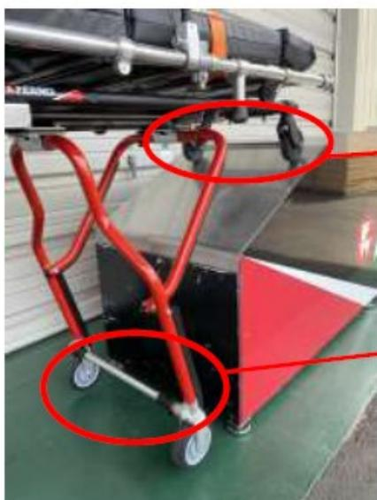
ローディングホイールが床面（防振架台）に接地している状態でローディングエントレックが完全に伸びきった事を確認してから5インチホイールを地面に接地させて下さい
